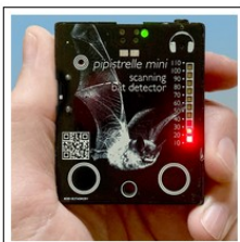
pipistrelle mini handheld bat detector / 384kHz USB microphone : APPROX £15 BUILD COST
