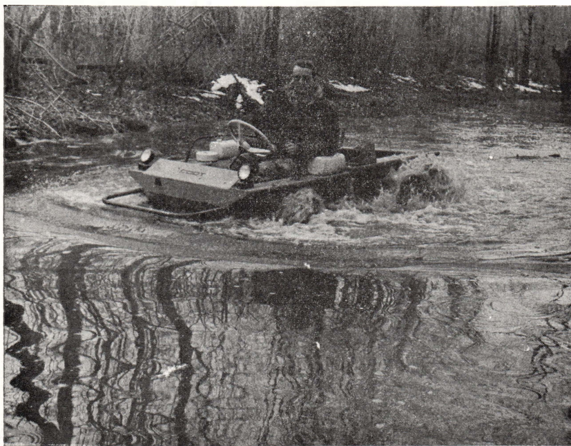
FIG. 5. — Camion amphibie de type COOT, utilisé pour la prospection et les traitements anti-larvaires.
