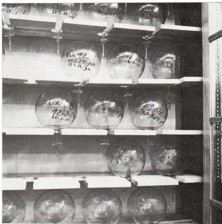
PHOTO 4. — Stockage des échantillons de méthane dans des ballons de 3 l.
